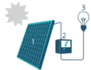
1. Zonnepaneel | 2. Omvormer | 3. Elektrische toestellen
